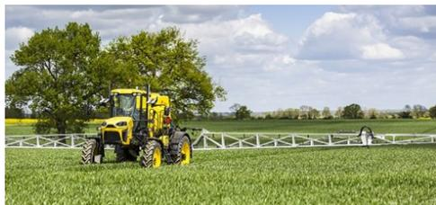
Le RS20 plus petit en gabarit, a tous de son grand frère. Uniquement en rampe arrière de 24 à 36 m et une voie variable de série. Grâce à son dégagement sous bâti, ce modèle peut se doter d'autres fonctionnalités notamment en l'équipant d'un relevage avant (castreuse, faucheuse andaineuse,) Il peut même servir de simple porte outil si on lui retire son système de pulvérisation.
