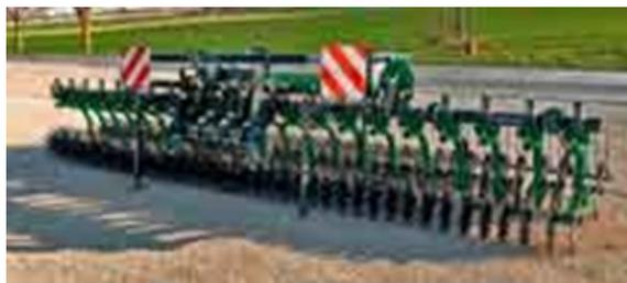
Ses points forts : - Des disques en fonte GS espacés tous les 75 mm pour un travail efficace sur toute la largeur de l'outil et un montage sur balancier qui permet une stabilité de la machine et une pression homogène.
